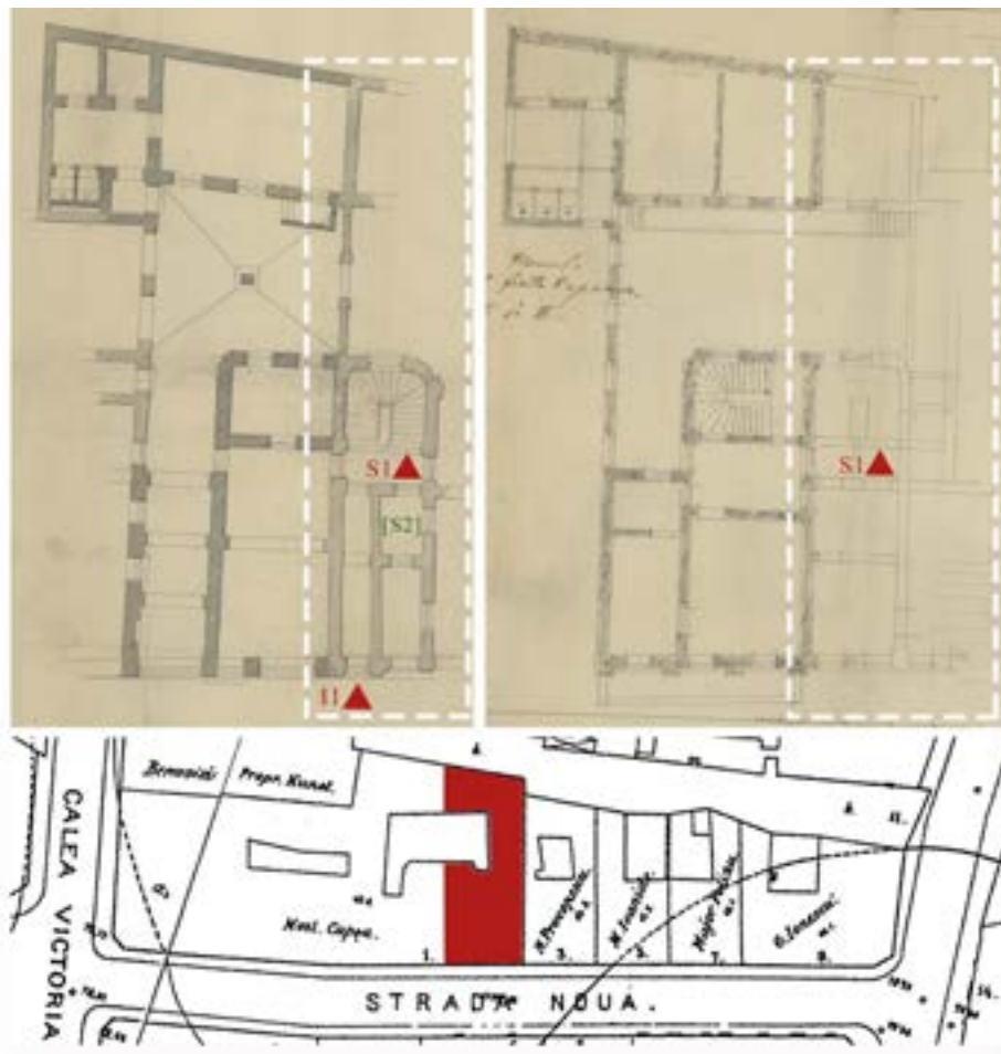
Fig. 10: (Sus) Proiectul extinderii casei Slătineanu din str. Nouă (depus 14 martie 1873): planuri parter și etaj I, cu marcarea joncțiunii cu casa Duschek. SMBAN, fond PMB Serviciul Tehnic, d. 15/1873, f. 57-58.
