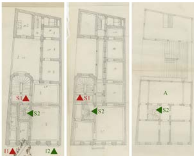
Fig. 9. Proiectul casei-atelier a lui Franz Duschek din strada Nouă (depus 13/25 ianuarie 1871): planuri parter, etaj I și II. SMBAN, fond PMB Serviciul Tehnic, d. 40/1871, f. 14-15. I1: intrarea care duce la scara principală; I2: intrarea clienților (ipoteză avansată în articolul de față); S1: scara principală; S2: scara clienților; A: camera principală de lucru a atelierului fotografic de la etajul superior.
