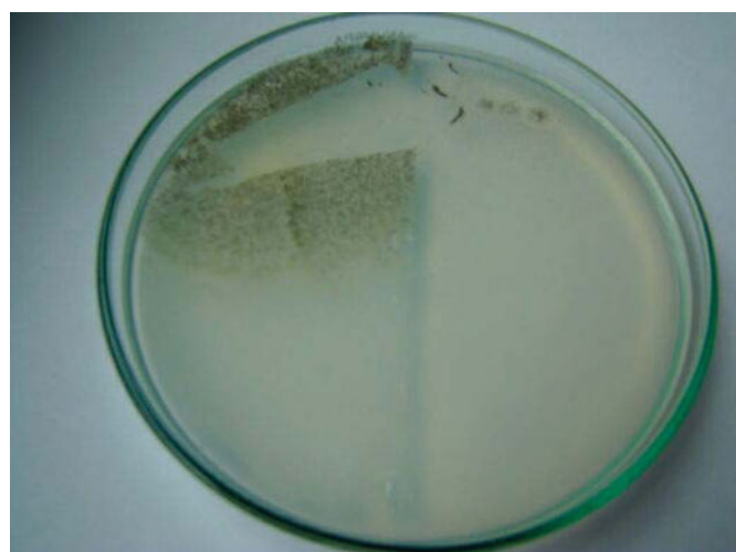
Foto 10. Efectul distructiv produs de fungi asupra celulozei din vâl după 20 de zile de incubare la temperatura camerei.
