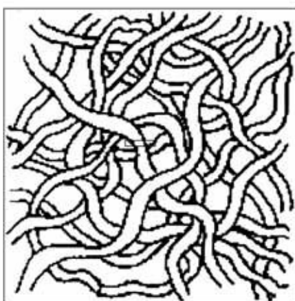
Fig. 2.b. Electonograma hârtiei de celuloză de rășinoase – lanțuri de celuloză
