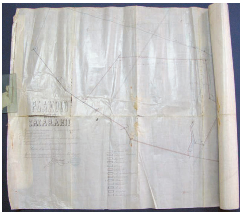
Fig. 6. Plan de moșie realizat pe pânză de calc (1874). Păstrare în stare rulată. Degradări: cute, șifonări, sfâșieri.
