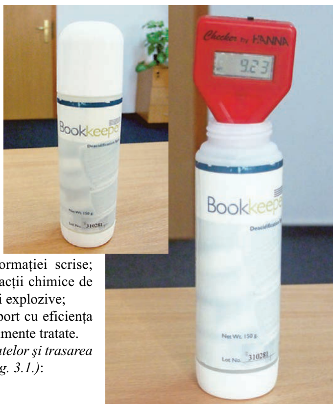
Foto 11. pH-ul produsului Bookkeeper. Determinări efectuate cu pH-metru model Hanna.
