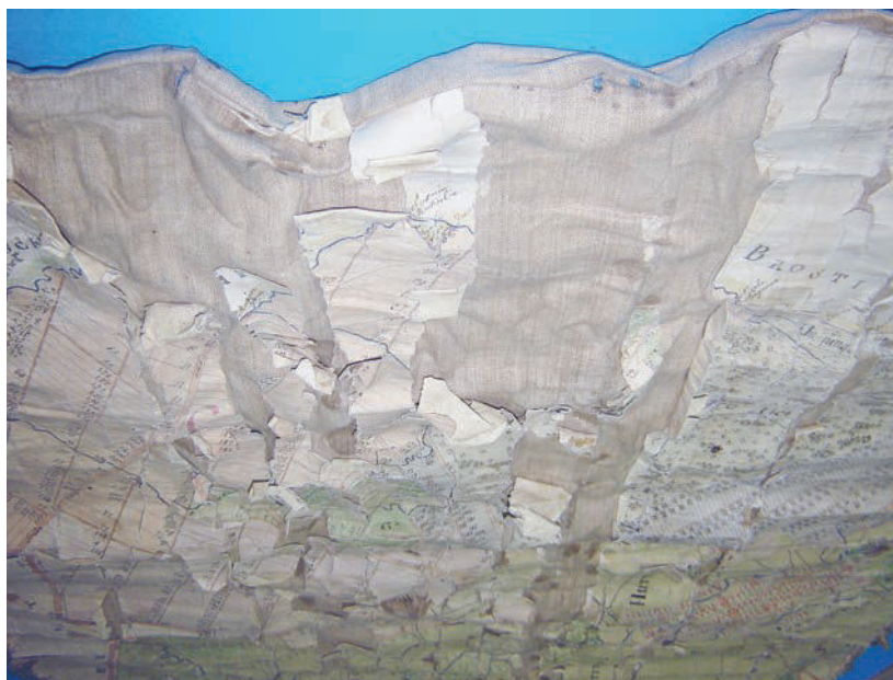
Fig. 13. Fig. 13. Plan topografic executat manual pe hârtie de desen, cașerat pe pânză (detaliu). Utilizarea excesivă, cu rulare și derulare repetată, a dus la dezintegrarea documentului în fragmente dintre care multe s-au pierdut.
