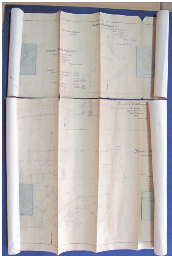
Fig. 12. Plan de moșie (1932), copie pe hârtie diazo păstrată în stare pliată și apoi rulat. Plieri forțate, sfâșieri.
