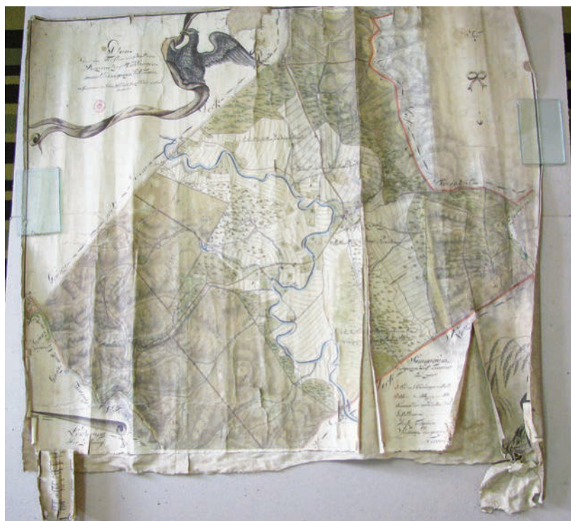
Fig. 3. Plan realizat manual pe hârtie de desen cașerată pe pânză (sec. XIX) păstrat în stare rulată. Prezintă cute, sfâșieri, pierderi de material grafic și chiar pierderi din pânza de cașerare.
