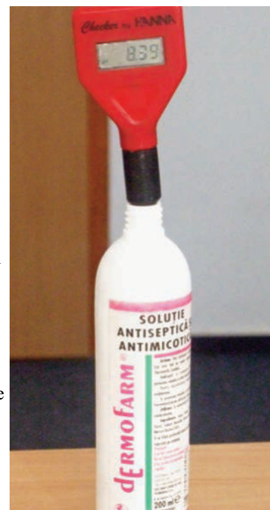
Foto 7. Produsul utilizat pentru decontaminarea și eradicarea biodegradărilor papetare. Compoziție: 100 gr. din care 25 gr. etanol (94%), 35 gr. 1-propanol; pH-ul soluției: 8,39.
