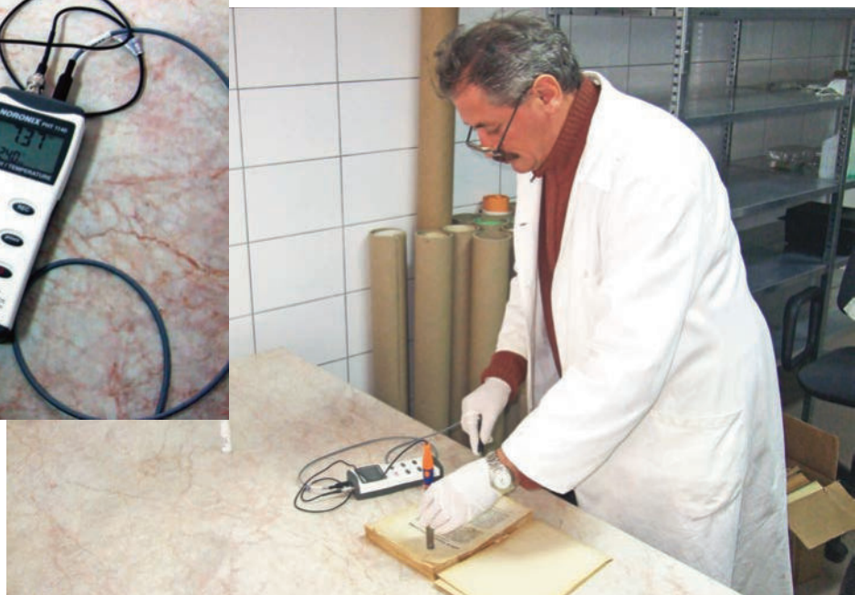
Foto 2 pH-metru model Noronix PHT 1140 pregătit pentru efectuarea determinărilor de aciditate.
