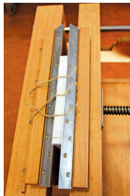
Foto 6. Formarea cotorului în presă.
