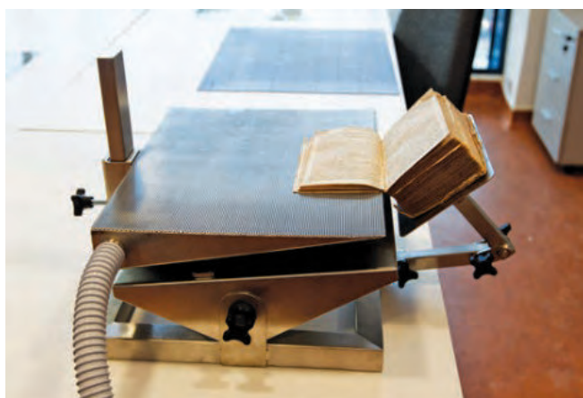
Foto 2. Suport de restaurare a filelor legate în cotor.
