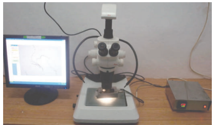
Figura 10. Echipament MHT aparținând Institutului de Cercetare Pielărie și Încălțăminte (ICPI)
