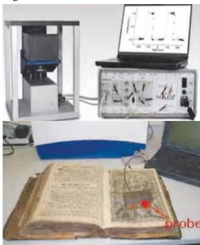
Figura 3. Instrumentul portabil NMR Mouse (Magritek) din dotarea INCDTP-ICPI și modalitatea de efectuare a unei măsuratori în cazul unui manuscris istoric
