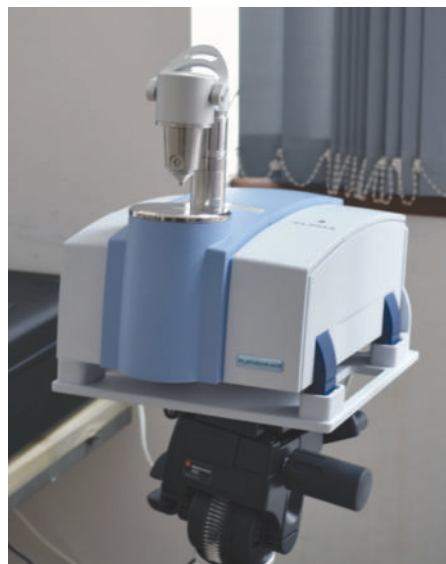
Figura 2. Spectrometru portabil Alpha Bruker Optics cu accesoriu ATR din dotarea MNIR
