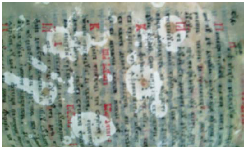
Foto 4. Testarea oxidului de magneziu în efectuarea tratamentelor de neutralizare a punctelor de aciditate papetară
