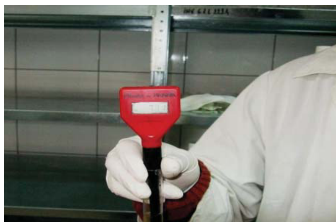
Foto 2. pH-metru Hanna, cu afișaj electronic
