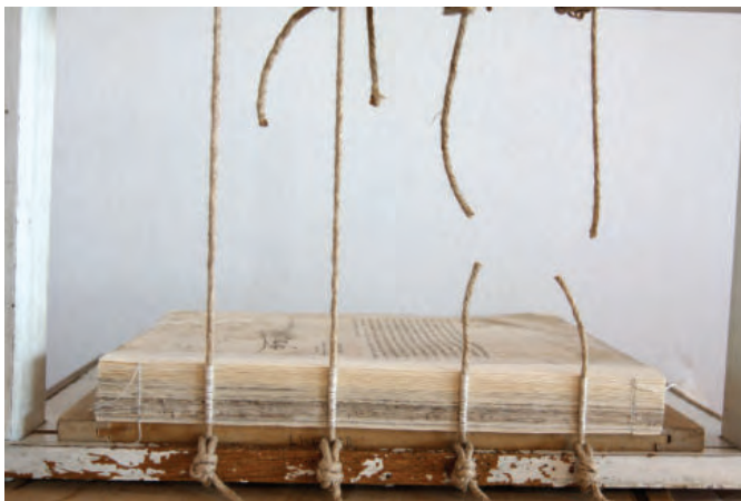
Foto 3. Imaginea blocului cărții după efectuarea coaserii cu ajutorul gherghefului
